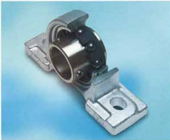
Bild 4 Die Gehäuselagereinheiten der „Ceraball“-Serie des Herstellers FYH sind mit einem Edelstahlgehäuse und Kugeln aus Siliziumnitrid-Keramik ausgerüstet und widerstehen auch extremen Temperaturen.
