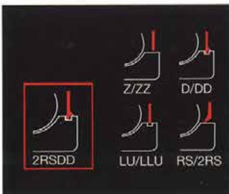
01 Der Einsatzzweck und die dafür am besten geeignete Befettung entscheiden über den optimalen Dichtungstyp
