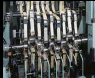
Power-Finisher Läppen von Kurbelwelle und Nockenwelle.
