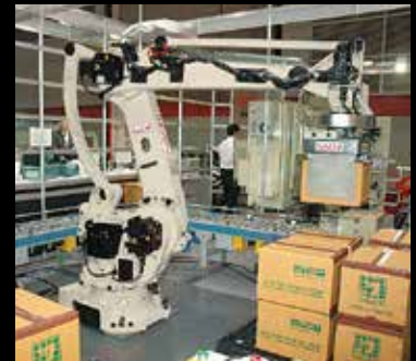
Palettierroboter „LP130/180“ Ermöglicht Hochgeschwindigkeits- / Hochpräzisions-Palettierung von Kartons, Säcken, Flaschen und Metallprodukten.
