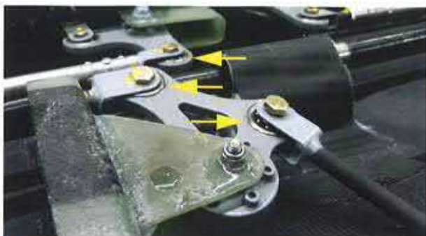
02 Bei den Gelenklagern und Kugelbuchsen, die in den Tragflächen des Segelflugzeugs AK-X zum Einsatz kommen, ist die richtige technische Dimensionierung besonders wichtig
