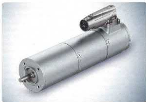
Motoren im Baukasten: Das neue ECI-42-Programm von EBM-Papst ermöglicht es Anwendern, eine passende Antriebslösung durch individuell kombinierte Module zusammenzustellen. Den bürstenlosen, elektronisch kommutierten Innenläufermotor gibt es mit Statorbaulängen von 20 und 40 mm, Leistungen von 45 und 90 W.
