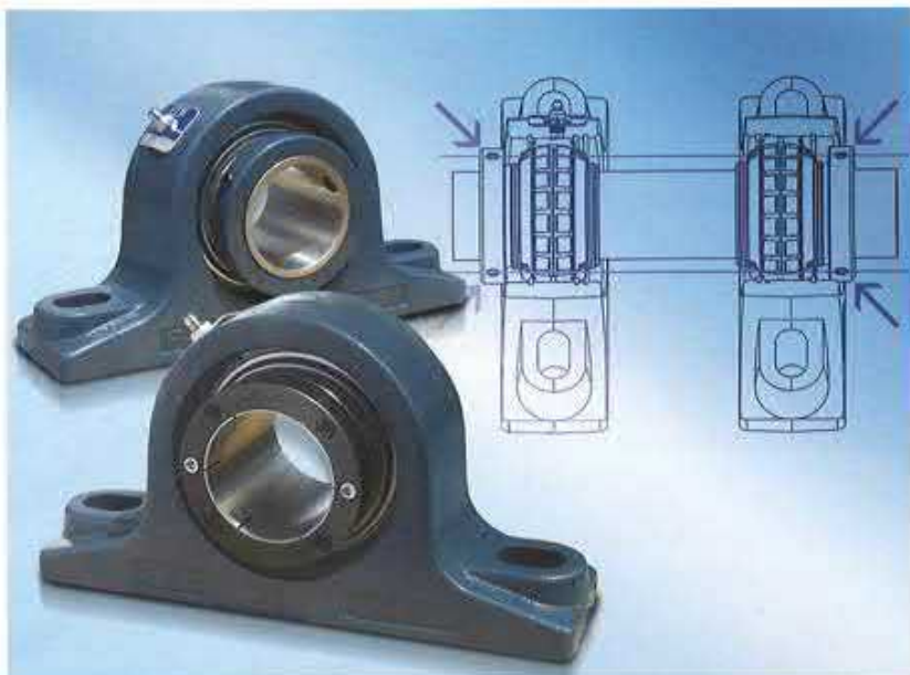
Bild 4 Bei bisherigen Lösungen konnte der Lagereinsatz nur über Madenschrauben auf der Welle fixiert werden. Festziehen der vier schwarzen Innensechskantschrauben bei Z-Lock wirkt wie eine Spannhülse mit 360° Kontakt bei extrem hohen Haltekräften ohne nachteilige Auswirkung auf das Pendelrollenlager. (Bild: Findling)
