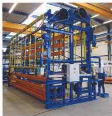
Ein gutes Beispiel für die individuellen Lagersysteme von Dornieden sind Umlauflager, die auch als Paternoster bezeichnet werden.
