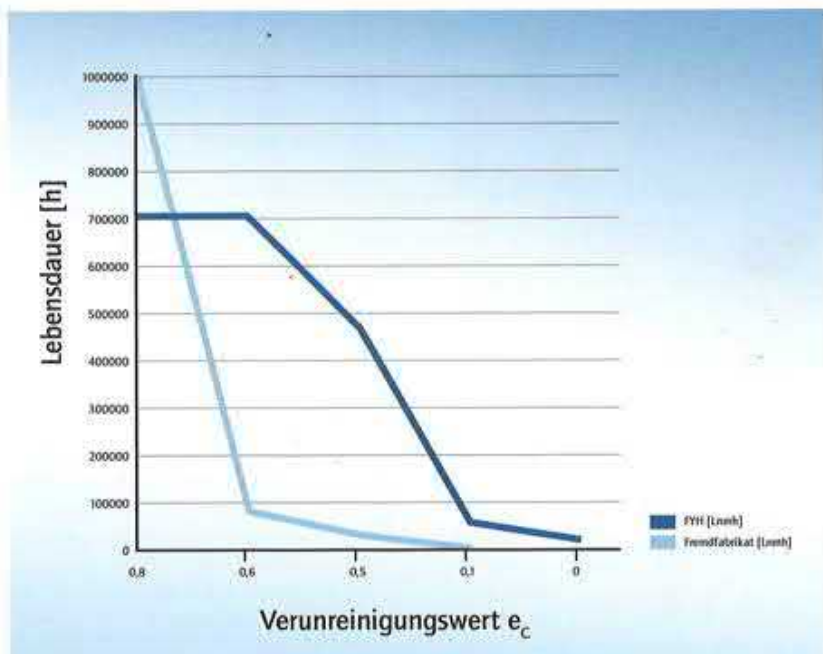
Bild 6 Die dreifache Lippendichtung der SRU-Lager gewährleistet in jeder Stellung einen perfekten Schutz gegen Verunreinigungen, was in einer deutlich verlängerten Lebensdauer resultiert. (Bild: Findling)
