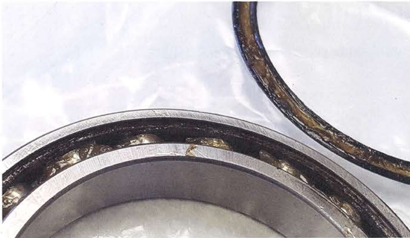
Unter anderem durch die filigrane Struktur der Ringe ergeben sich Probleme bezüglich der Dichtungstechnologie – wenn die Dichtungen versagen, können Verunreinigungen in die Dünnringlager gelangen.
