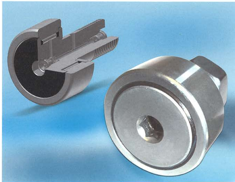
Bild 4 Im Sortiment von Findling Wälzlager finden sich auch robuste Kurvenrollen, die eine Sonderform der Nadellager darstellen; im Bild eine oberflächenbeschichtete Ausführung, die 96 Stunden im Salzsprühnebeltest besteht. (Alle Bilder © Findling)
