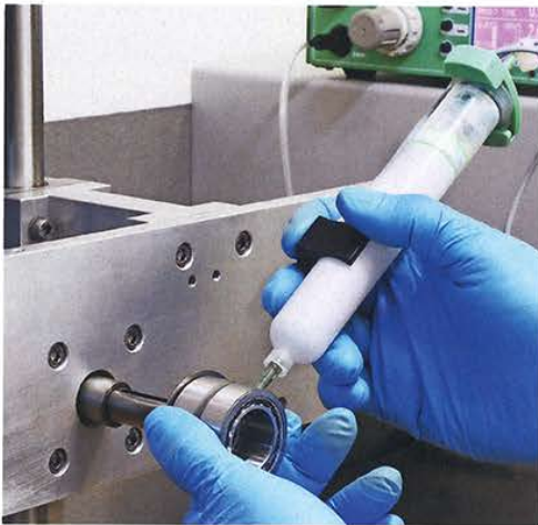
Die Sonderbefettung von Wälzlagern ist der neueste Baustein im breit aufgestellten Service-Netzwerk von Findling. Foto: Findling
