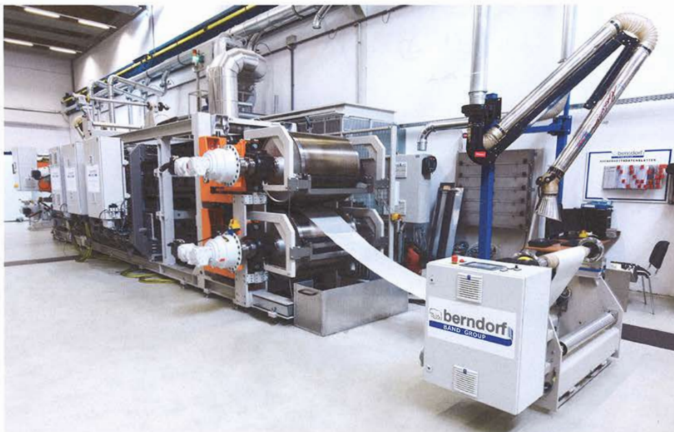
Bild 1 In den Doppelbandpressen der Berndorf Band Group werden beispielsweise Kunststoff-Granulate geschmolzen, um sie anschließend in die gewünschte Form pressen zu können.
